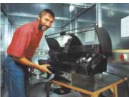
ESD-Test einer Brotschneidemaschine im EMV-Labor.
